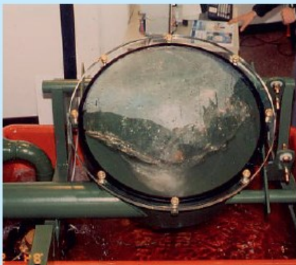
Obr.5: naskočení vírového proudění při vzrůstajícím tlaku
