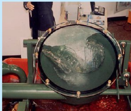
Obr.5: naskočení vírového proudění při vzrůstajícím tlaku
